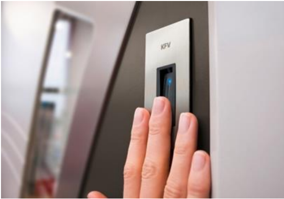
Zutrittskontrolle über Fingerprint
