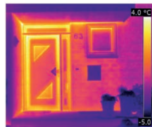
Vor der Sanierung – rote Farbe bedeutet hoher Energieverlust
